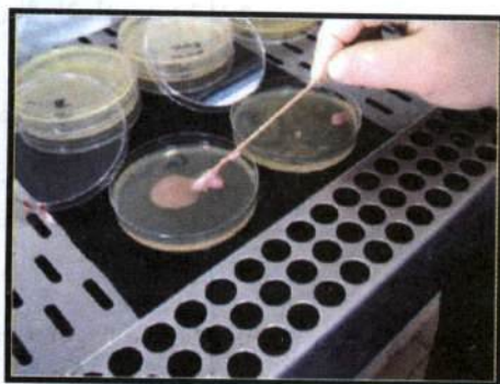
بروسلا در محیط آزمایشگاه به راحتی منتقل می شود و باید اقدامات تشخیصی باکتریولوژیک تحت هودهای امنیتی مناسب و با پوشیدن وسائل محافظتی انجام شود
