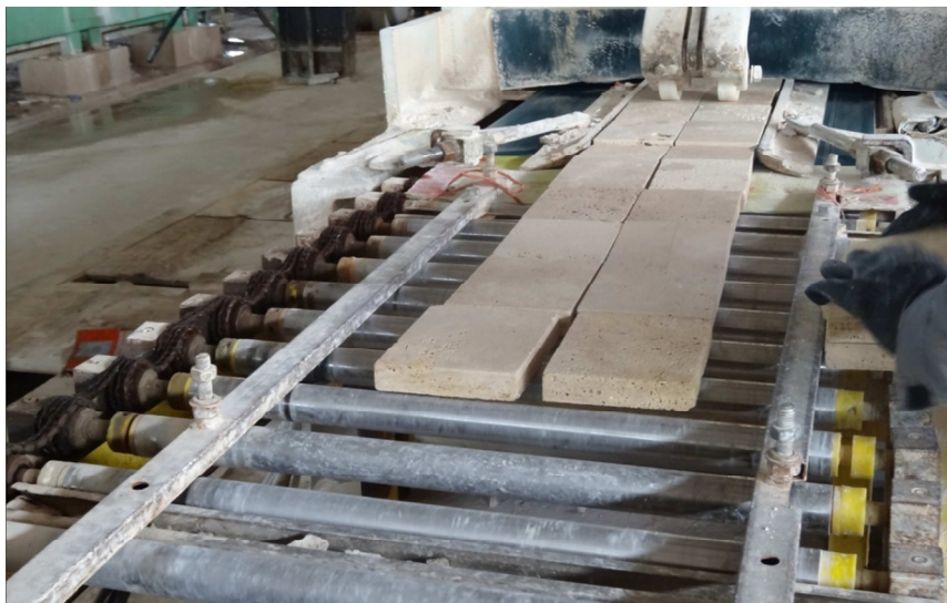
شکل ۲-۶: دستگاه ساب (نقاله)
