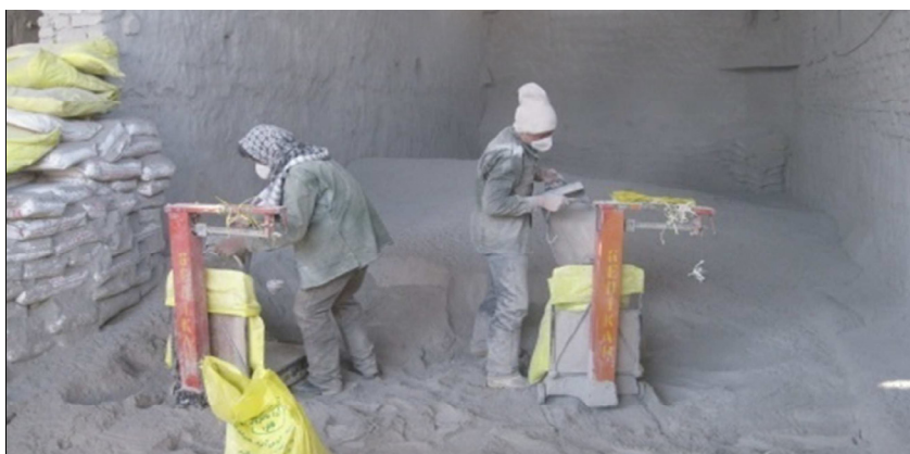
شکل ۳-۲: پر کردن و وزن کردن کیسه های سیمان
