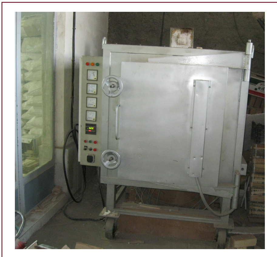
شکل ۵-۲: کوره صنعتی در کاشی سازی سنتی
