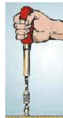
شکل ۲۴-۱: ابزارهای متناوب می توانند فشار مکانیکی را کاهش دهند مثل آچارپیچ گوشتی مجهز به ضامن.
