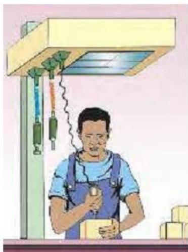
شکل ۳-۲۰: چهار چوب مخصوص بالای سر با مکانیسم فنری برای ابزارهای آویزان نصب کنید.
