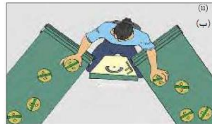
شکل ۵-۳: چیدمانی ایجاد کنید که به کارگر اجازه دهد در حالیکه وضعیت طبیعی بدن را حفظ می کند اشیاء را از یک نوار نقاله به بخش بعدی حرکت دهد. صفحه فلزی و نقاله انتقالی جابه جایی اشیاء را آسان تر می کند (الف) و (ب).
