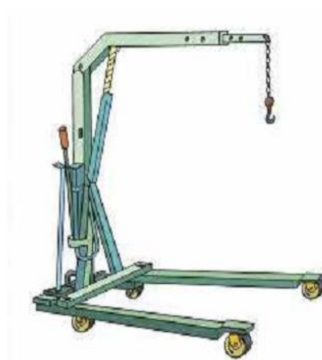
شکل ۹-۳: جرثقیل زمینی هیدرولیکی دستی با یک بازوی متحرک تلسکوپی
