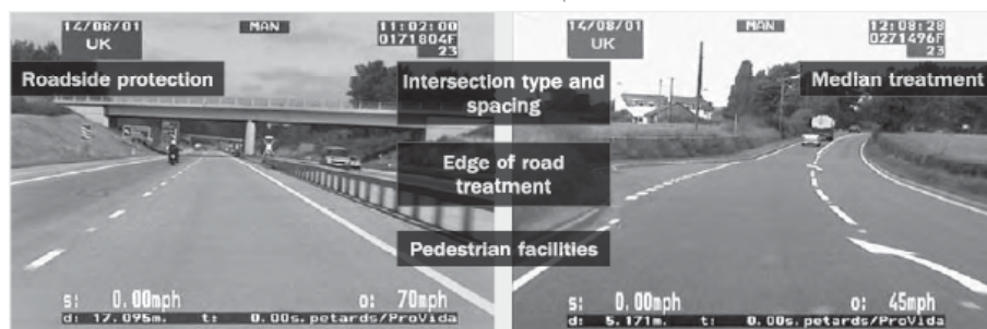
شکل ۲: عناصر طراحی سطح بالای مشابه، در جاده‌های با استاندارد متفاوت قابل ارزیابی است
