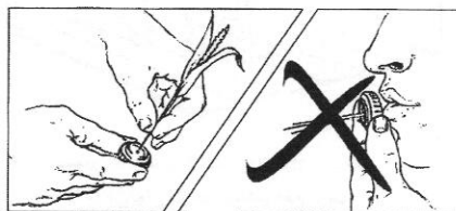
تصویر ۱۲: برای باز کردن گرفتگی نازل از وسیله‌ای نازک و نرم استفاده کنید
