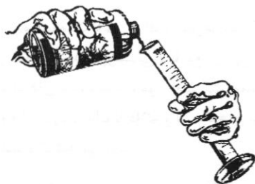
تصویر ۱۳: توصیه می‌شود که در هنگام ساخت محلول از دستکش مناسب استفاده شود
