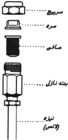
تصویر ۲۸: اجزای تشکیل دهنده نازل
