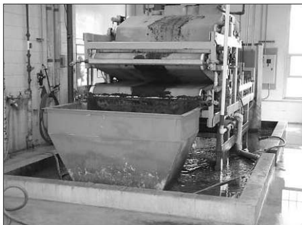
شکل ۲- دستگاه فیلترپرس برای آگیری جامدات زیستی
