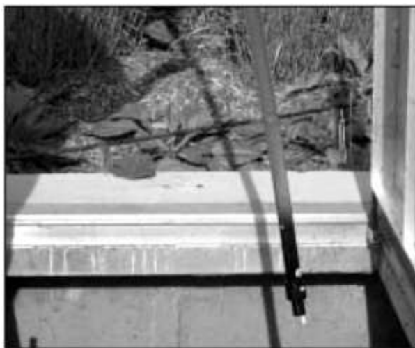
شکل ۵- دستگاه لجن‌سنج هنگام برداشت نمونه جامدات زیستی
