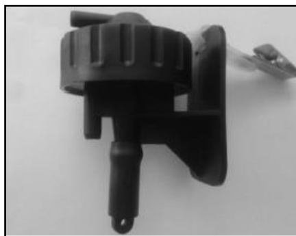
شکل ۶- سیکلون جهت نمونه‌برداری از ذرات قابل استنشاق
