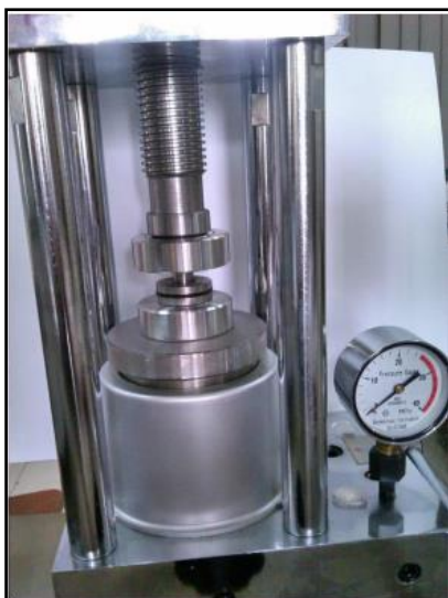
شکل ۱۱- دستگاه پرس در دستگاه FT-IR
