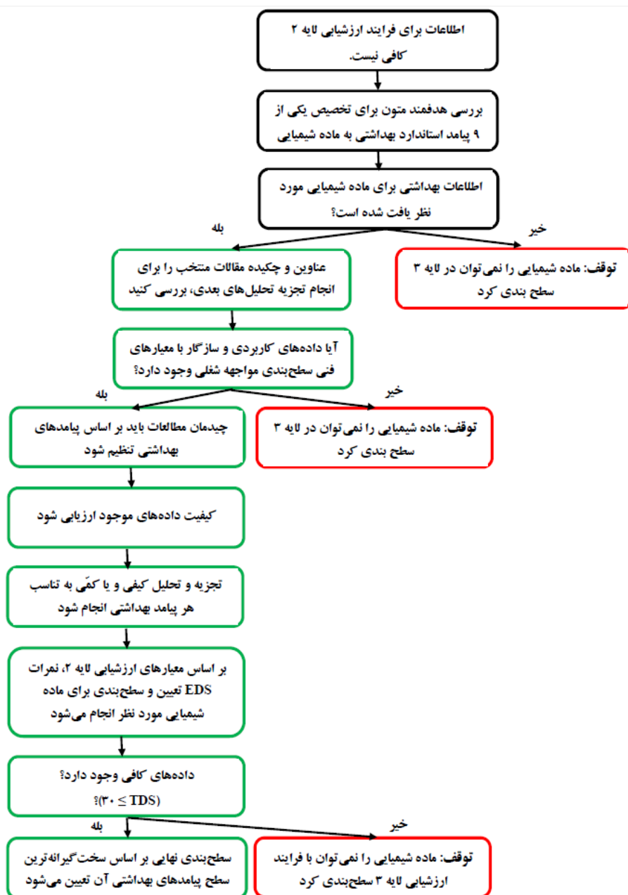
شکل ۰-۱) طرح شماتیکی از سلسله مراتب ارزشیابی لایه ۳ از فرایند OEB
