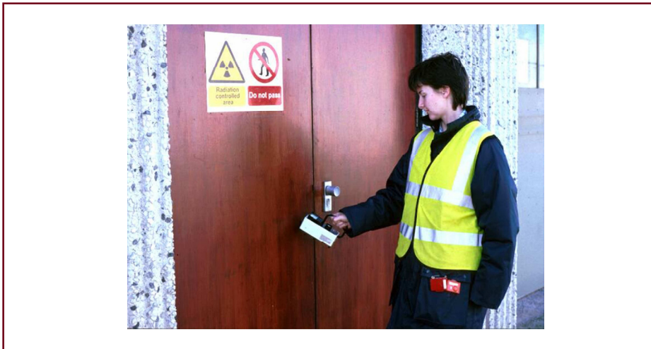
شکل ۶۳- مونیتورینگ پرتو نشستی پشت در اتاق های پرتونگاری
