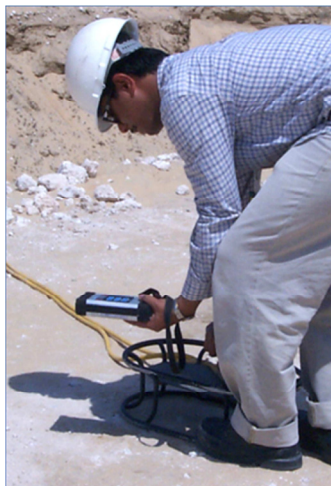
شکل ۶۵- اندازه گیری آهنگ دز در محل کار اعضای تیم پرتونگاری
