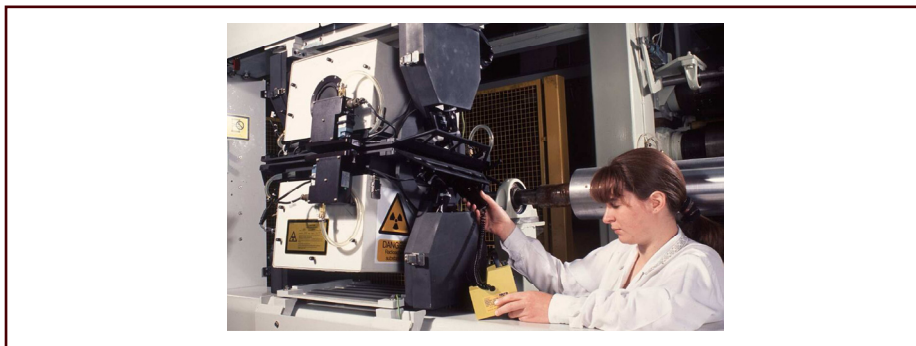
شکل ۶۶- حداکثر آهنگ دز نباید در فاصله 5 سانتیمتر از سطح خارجی کانتینر بیشتر از 500 \mu\text{Sv/h} باشد.
