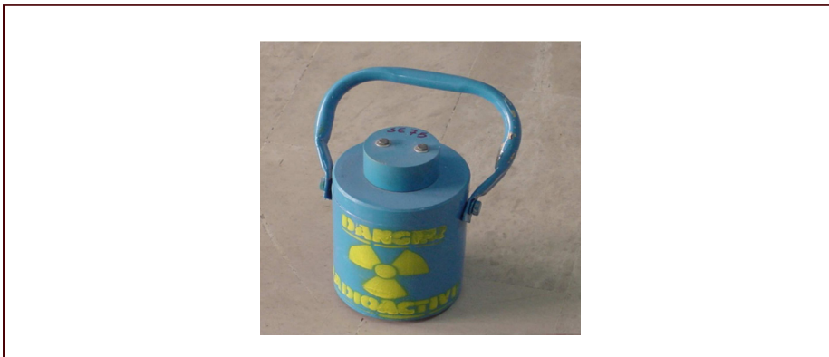
شکل ۸۵- نمونه ای از محفظه نگهداری چشمه پرتونگاری صنعتی
