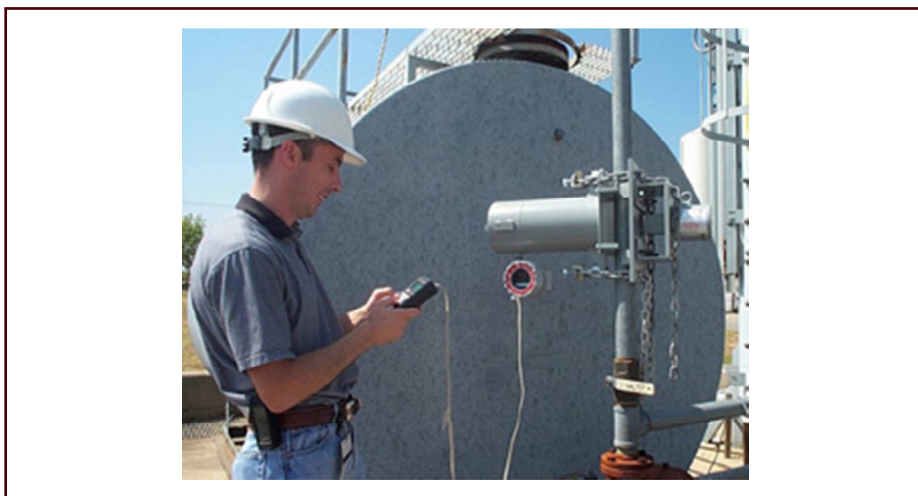
شکل ۲۲- اندازه گیری چگالی در خروجی چاه نفت
