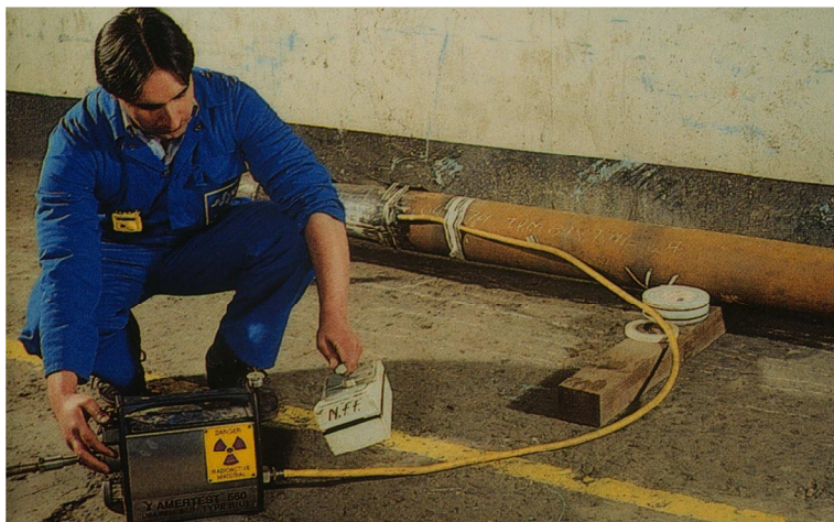
شکل ۱۰- دوربین پرتونگاری صنعتی
