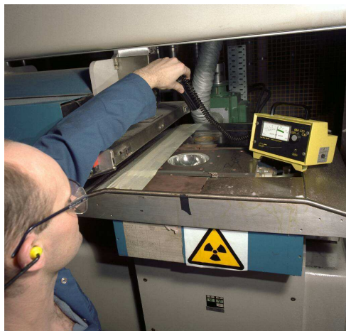
شکل ۶۰- مونیتورینگ پرتو هنگام تعمیر سنجشگر پرتوی
