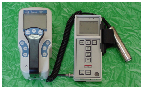
شکل ۵۷- انواع دزیمتر محیطی جهت سنجش پرتوهای گاما و بتا
