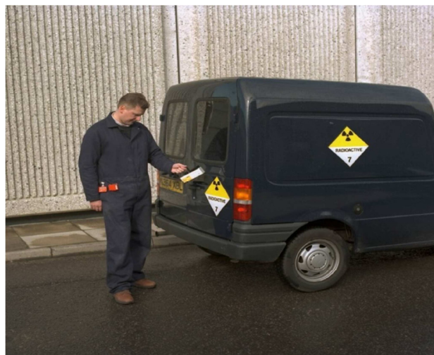
شکل ۵۹- مونیتورینگ پرتو در سطح وسیله نقلیه
