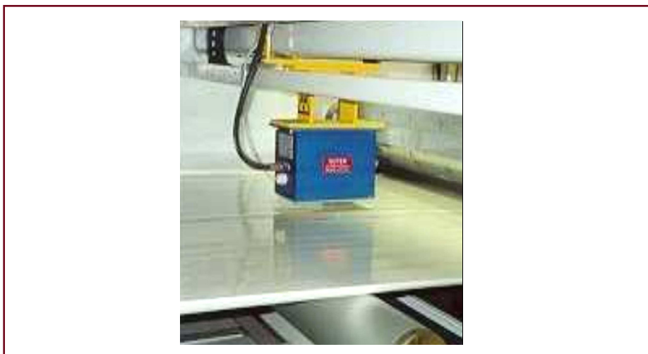
شکل ۱۶- کاربرد روش پس پراکنی در ضخامت سنجی
