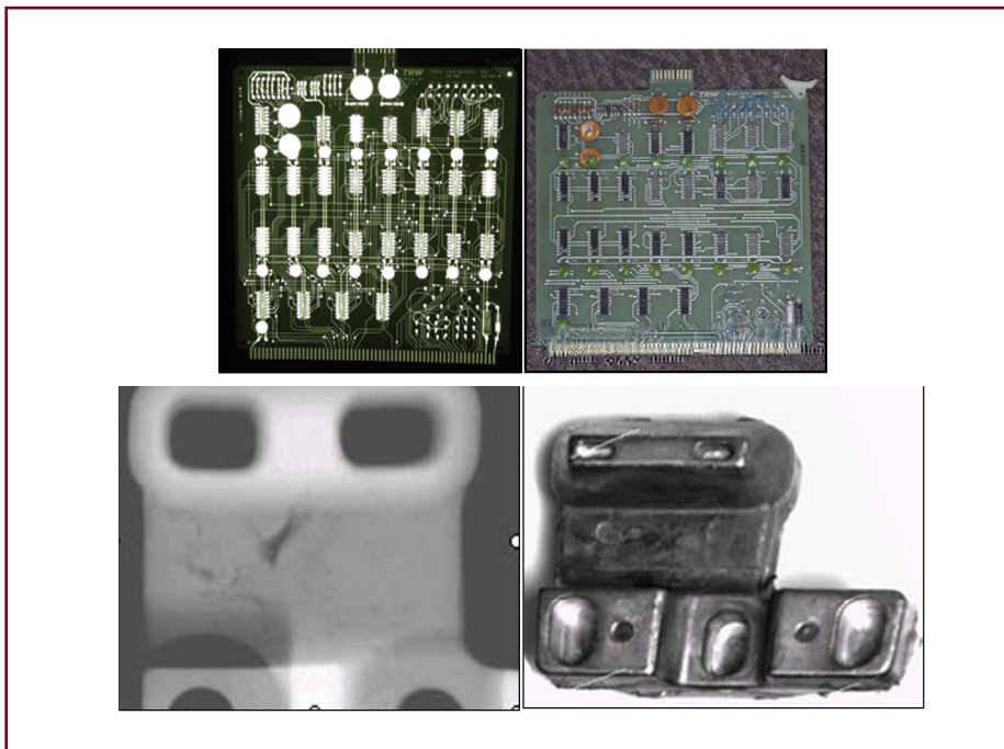
شکل ۸- انواع تصاویر پرتونگاری صنعتی
