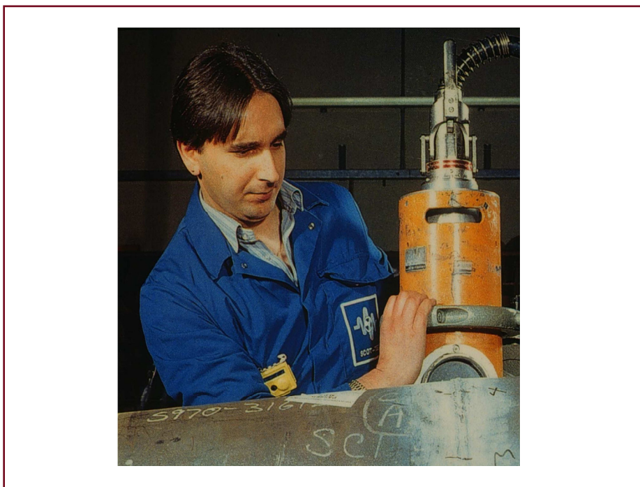
شکل ۹- دستگاه اشعه ایکس پرتونگاری صنعتی
