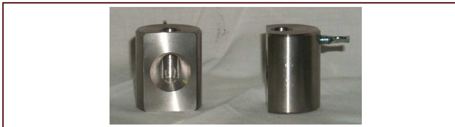
شکل ۷۹- کالیماتور یا محدود کننده پرتو
