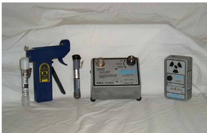
شکل ۸۴- نمونه هایی از ابزار مونیتورینگ فردی در عملیات پرتونگاری صنعتی
