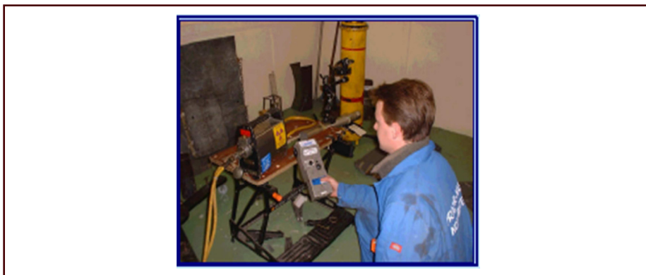
شکل ۸۳- نمونه ای از روش انجام مونیتورینگ محیطی در عملیات پرتونگاری صنعتی
