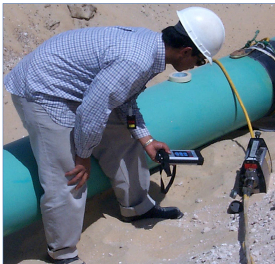
شکل ۶۱- مونیتورینگ پرتو پس از پایان پرتودهی به منظور اطمینان از بازگشت چشمه
