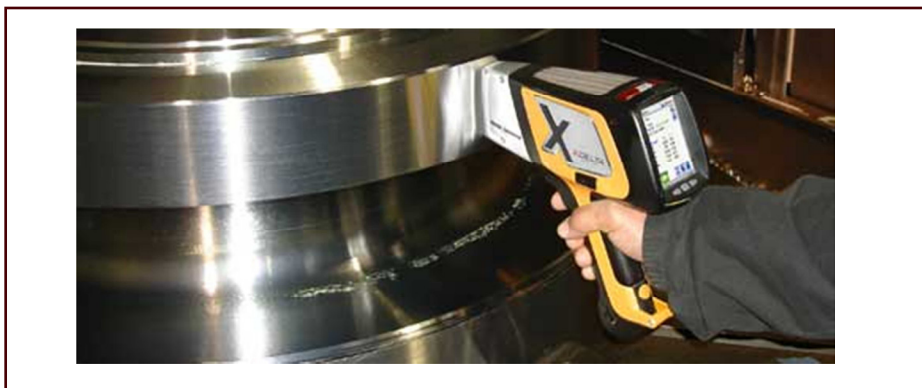
شکل ۲۸- دستگاه آنالایزر قابل حمل XRF
