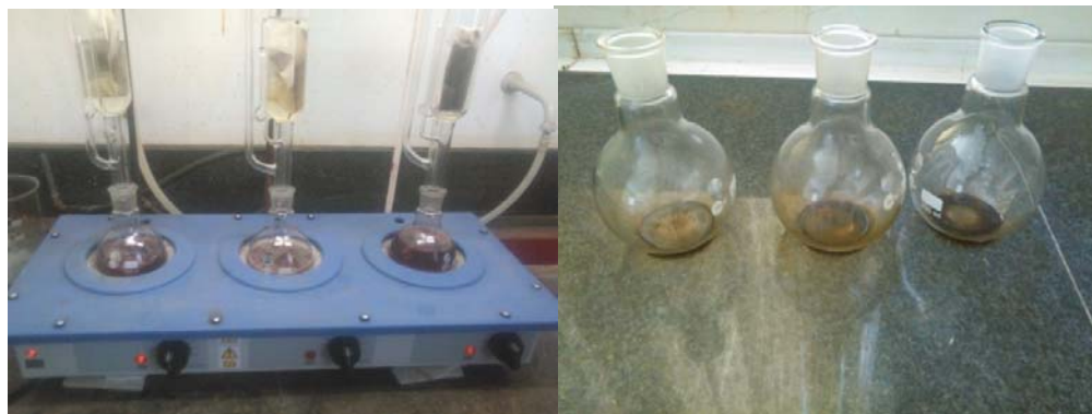
۴-۷. دستگاه سوکسله و مسیر حرکت حلال نفتی در آن
