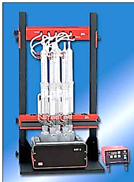
شکل 4-6. دستگاه سوکسله و مسیر حرکت حلال در آن
